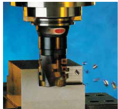
Power-Fräsen mit Graflex® modulare System: Zeitspanvolumen 432 cm 3 /min
